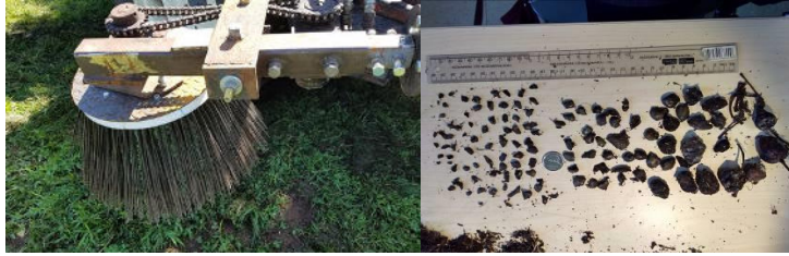
Ajout d'une brosse à balai de rue Résidus de pommettes suite au passage du broyeur Eliminae MD
