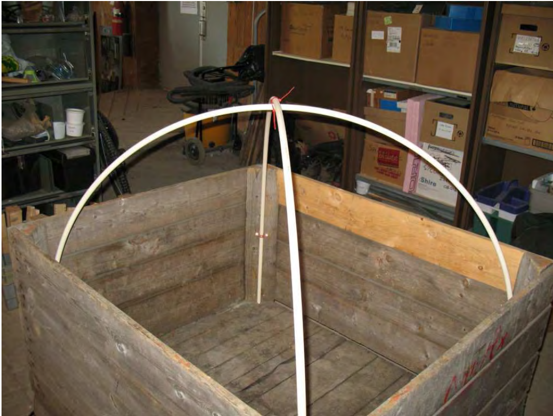
Photo 2. Détail de l'armature en CPVC pour le dispositif d'emballage de bennes
