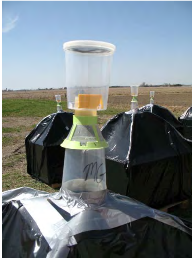
Photo 3. Détail de la pièce collectrice du dispositif d'emballage de bennes
